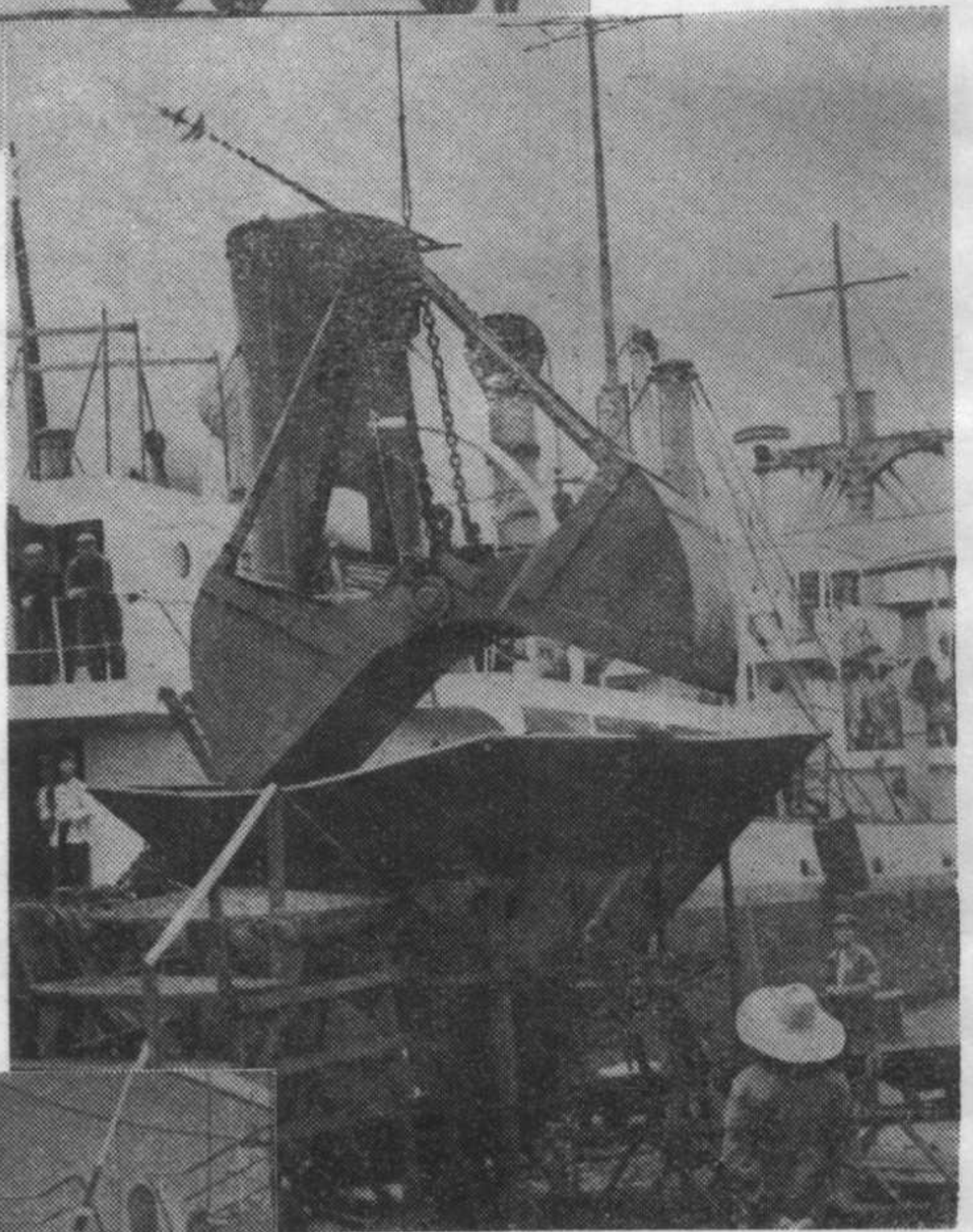
散货装卸使用抓斗、漏斗、皮带机联合操作
